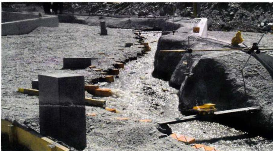
Abbildung 2: Gamsamodell im Bereich der Société Suisse des Explosifs für einen Abfluss von  $82\text{m}^3/\text{s}$ .
